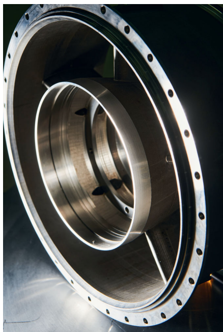
Рис. 1. Опора переднего подшипника перспективного турбовинтового двигателя
