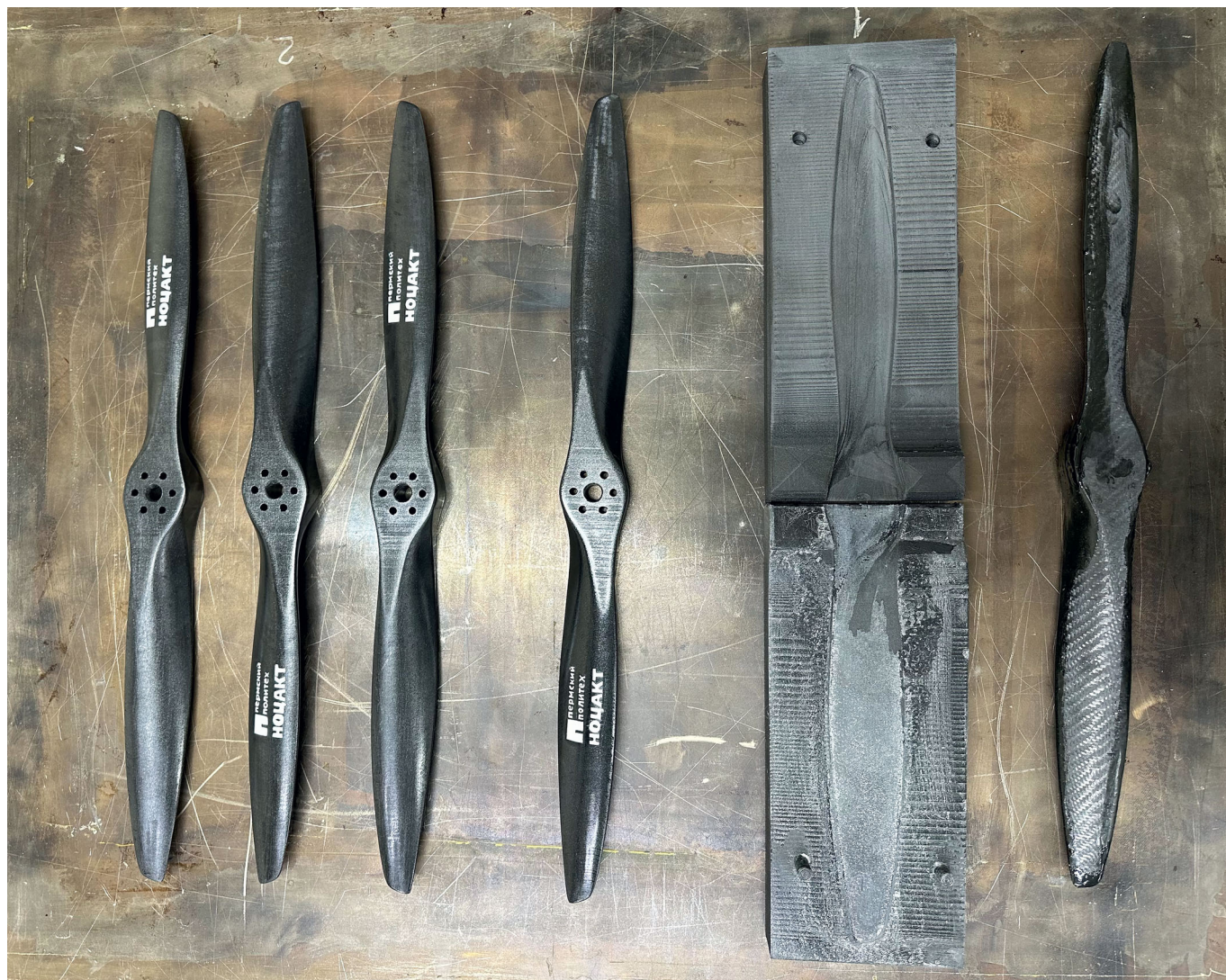
Рис. 3. 3D-печать для создания винтов: прототипы лопасти, напечатанные на F2 Lite (4 штуки), оснастка для выкладки ПКМ, напечатанная на F2 Lite, выложенная композитная деталь из углеткани. Фото: F2
