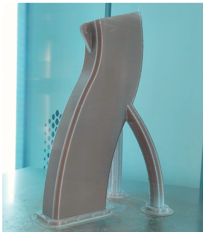
Рис. 2. Авиационные детали: а) элементы воздуховода, напечатаны из PEEK на F2 Lite, б) корпус редуктора, напечатан из PEEK на F2 Quart. Фото: F2
