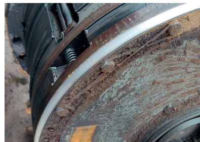
Рис. 14. Прокладки бортовой коробки передач танка Т-72 (TPU D70)
