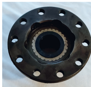
Рис. 13. Кольца уплотнительные для конической передачи танка Т-72 (TPU D55)
