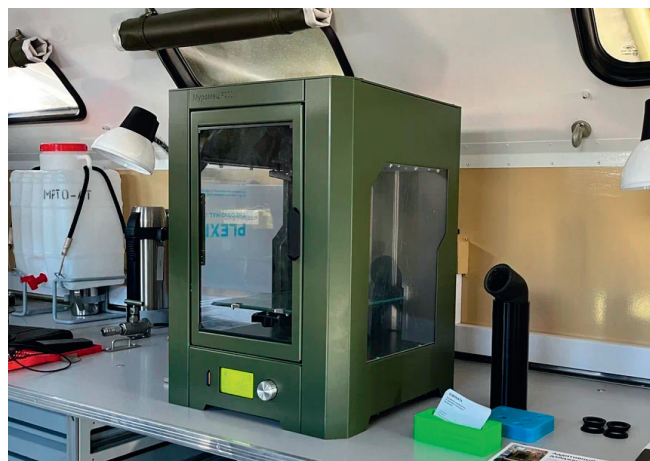
Рис. 10. 3D-принтер «Муромец» в составе мобильной ремонтной мастерской
