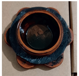
Рис. 8. Прокладка крышки маслозаливной горловины АМ «КАМАЗ» (TPU A70)
