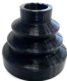
Рис. 12. Защитный чехол автомобиля «Уаз-469» (TPU A70)
