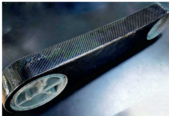
Манипулятор из композиционных материалов
