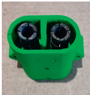
Рис. 6. Разъем подключения внешнего запуска ПС-315 для «КАМАЗ» (Clotho ABS GF13)
