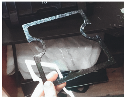
Рис. 7. Изготовление прокладки клапанной крышки «КАМАЗ» 740.1003270-11 (TPU A70)
