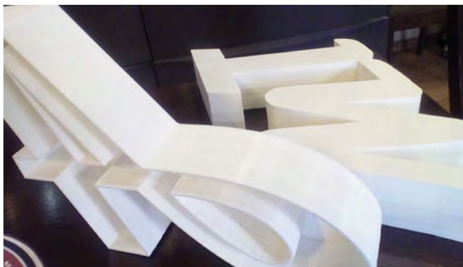
Рис. 15. Пример печати из термопластика на 3D-принтере «Бегемот», высота букв 300 мм
