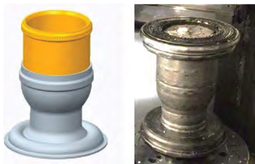
Рис. 6. Камера сгорания после наплавки проволоки из сплава Inconel 625
