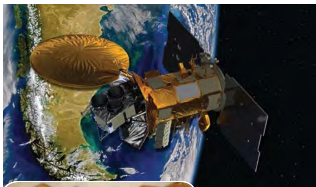
Золотистые листы каптона на элементах спутника
