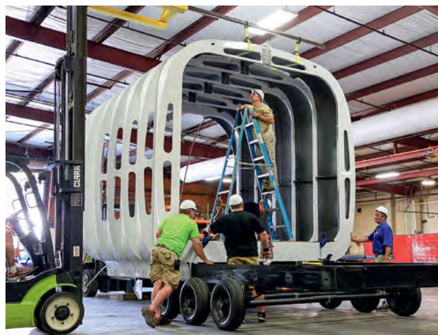
Рис. 11. Дом-автомобиль и сборка дома из панелей на шасси, комплект
