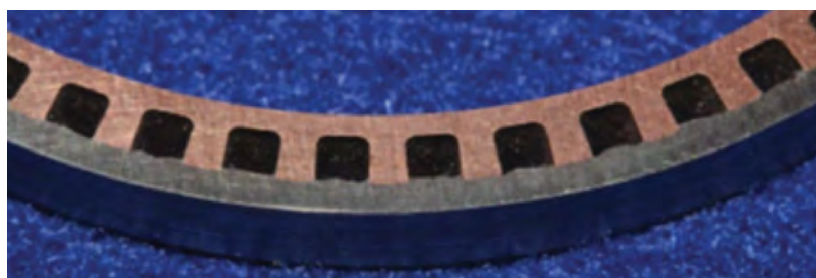
Рис. 7. Поперечное сечение стенки камеры сгорания
