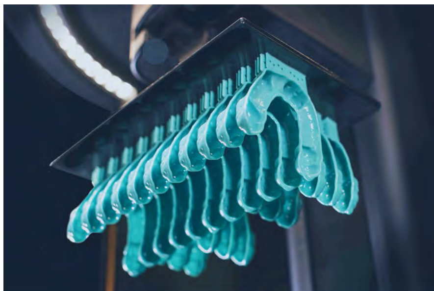
Рис. 4. Модели напечатаны на принтере M2 carbon [11]
