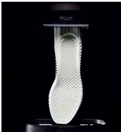
Рис. 3. Печать подошвы по технологии Carbon
