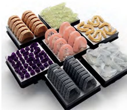
Рис. 5. Рабочие платы с напечатанными готовыми изделиями (принтер Form 2)
