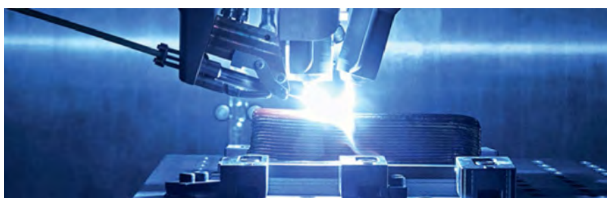
Рис. 3. Процесс получения изделия методом многослойной плазменной наплавки с использованием титановой проволоки. Изображение компании Norsk Titanium
