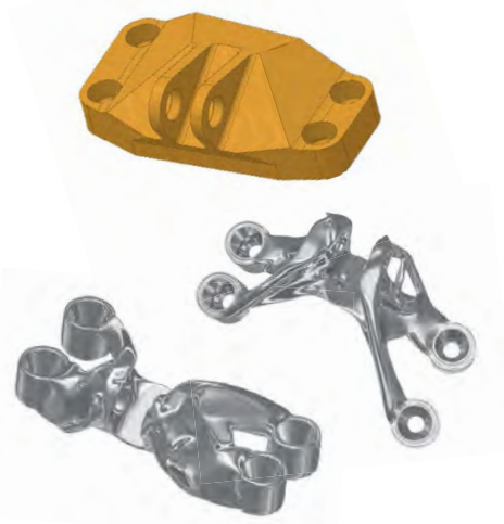
Рис. 2. Варианты конструкции кронштейна авиационного двигателя
