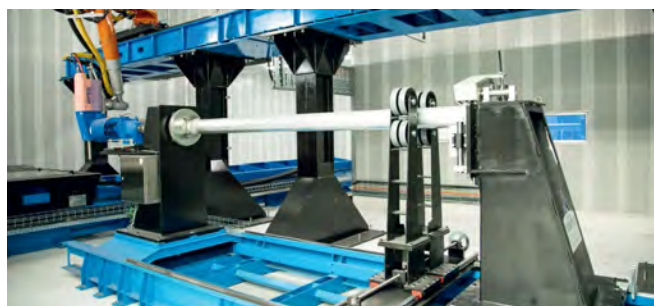
Рис. 1. Роботизированный 3D-принтер, работающий по технологии ХГН
