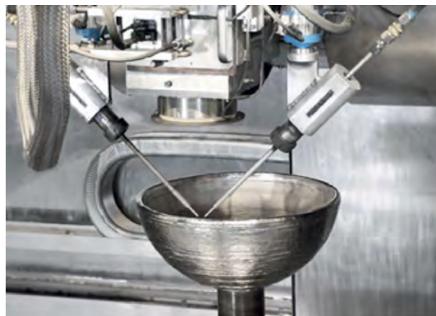
Рис. 4. Технология Sciaky's EBAM. Изображение компании Sciaky [9,10]
