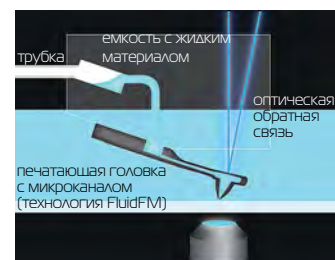
Рис. 1. Схема работы микропринтера
