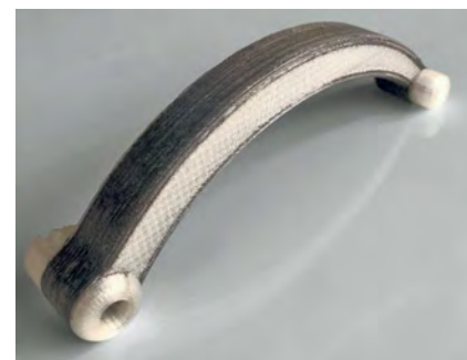
Рис. 16. Пример рукоятки, выполненной по технологии CFC
