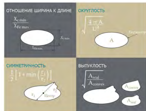
Рис. 2. Некоторые параметры формы частиц, определяемые методом динамического анализа изображений.
