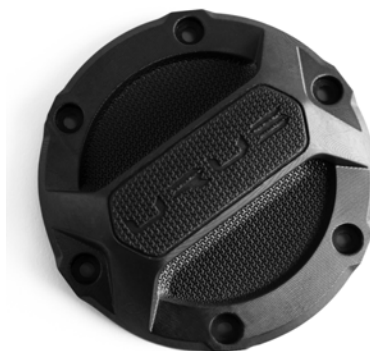
Рис. 7. Вентиляционный короб (а) на панели Lamborghini SiánS (b), напечатанный на принтере L1 Carbon
