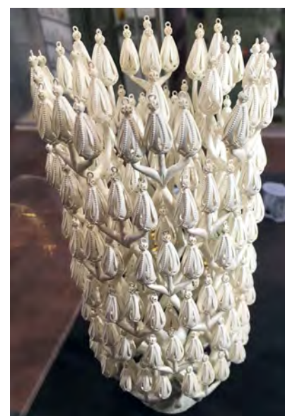
Рис. 12. Пример массового изготовления моделей для литья по выплавляемым моделям: а) напечатанные «елки» с моделями (около 4000 штук) на принтере DWS 030J; б) отливка напечатанной «елки»
