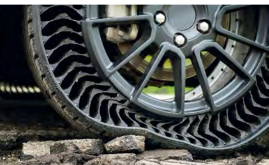
Рис. 8. Пример UPTIS шины от Michelin
