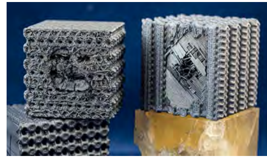
Рис. 21. Напечатанные из нановолокон пуленепробиваемые кубы.
