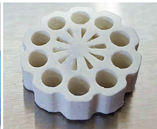
Рис. 2. Примеры керамических изделий, изготовленных по методу SLA
