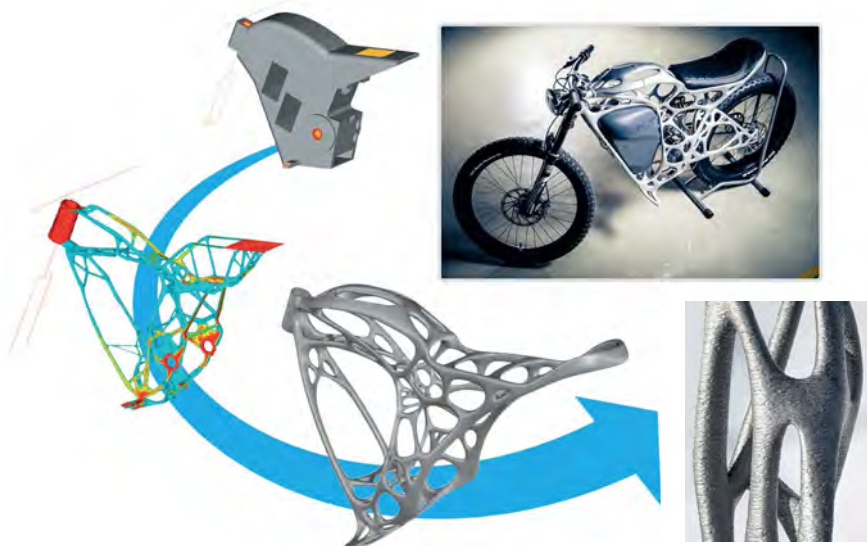
Рис. 13. Рама мотоцикла, сконструированная с помощью программы Altair с учетом топологической оптимизации. Уменьшение веса на 30%.
