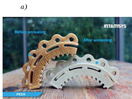
Рис. 23. Напечатанные детали: а) из материала PEEK до отжига (слева) и после, б) из материала ULTEM 9085
