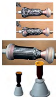
Рис. 7. Производство композитной камеры сгорания
