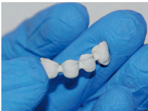
Рис. 2. Примеры керамических изделий, изготовленных по методу SLA
