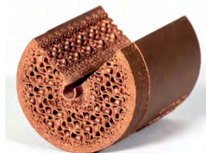
Рис. 11. Образец печати теплообменника со сложной структурой каналов
