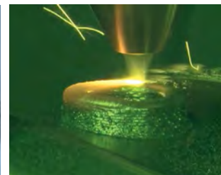
Рис. 3. Система холодного газодинамического напыления порошка
