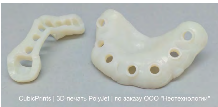
Рис. 1. Напечатанная из фотополимера модель челюсти
