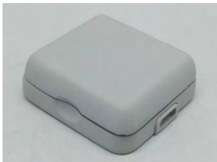
Рис. 3. Обработанная мастер-модель из фотополимера
