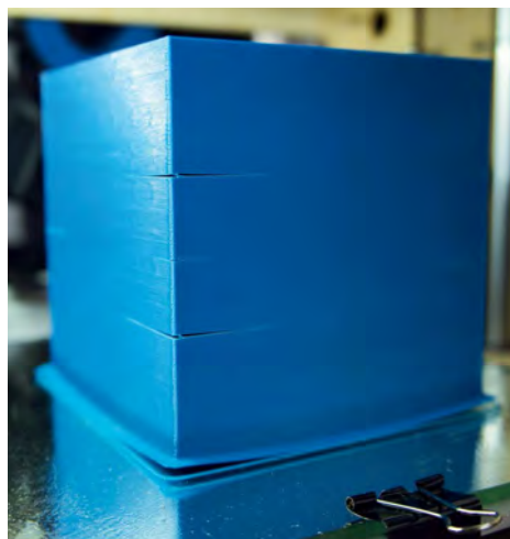
Рис. 3. Куб 10×10×10 см с заполнением 5%, напечатанный из ABS и AEROTEX
