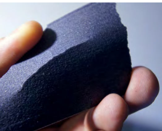
Рис. 7. Пластика 1 мм толщины, напечатанная вертикально. Трещина при механическом разрушении идет в произвольном направлении, что свидетельствует об однородности механических свойств вдоль и поперек слоев распечатки
