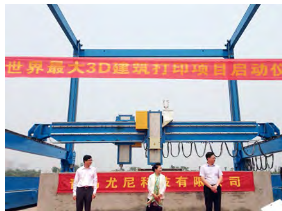
Рис. 3. Портальный 3D-принтер компании Winsun (Китай)
