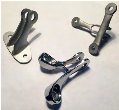
Рис. 5. Оптимизированный и изготовленный кронштейн с использованием технологий SLM и LMD
