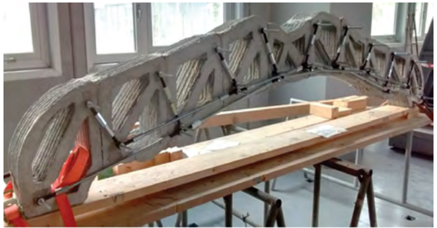
Рис. 18. Арка моста в сборе с металлическими усилениями
