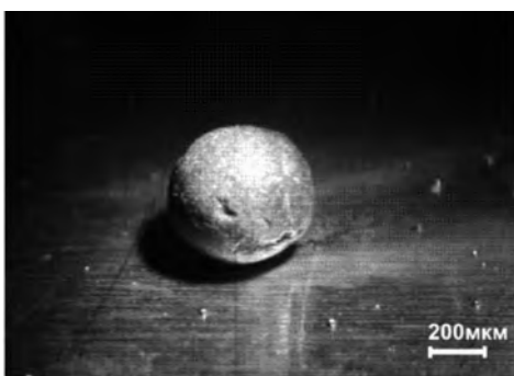
Рис. 4. Трехкратное облучение одного слоя порошка
