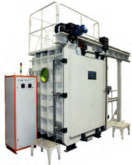
Рис. 7. Установка «СЛС-1» для реализации технологии SLM
