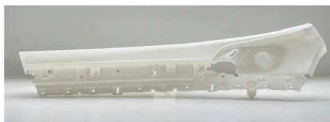
Рис. 6. Секция передней левой двери с сеткой динамика, напечатанная на 3D-принтере ProtoFab SLA600 из фотополимера Formula W
