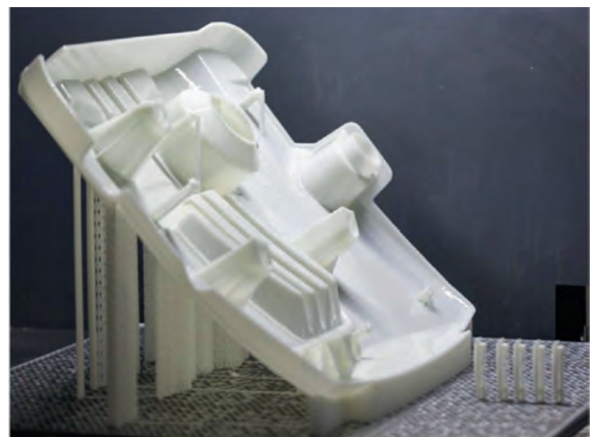
Рис. 2. Крышка двигателя напечатана на 3D-принтере как цельный объект
