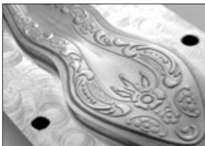
Рис.1. Фрагмент электрода для выжигания чеканочного штампа для ложки столовой
