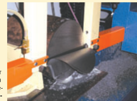
Рис. 3. Станок способен отрезать пластину 0,6 мм от заготовки диаметром 220 мм
