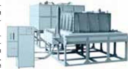
Корпус электропечи состоит из двух сопрягаемых частей: платформы (подставки) и колпака, образующих рабочее пространство печи. На поддон, уложенный на подовой части платформы, устанавливается герметичный муфель из жаропрочной стали. Снаружи муфель закрывается футерованным колпаком с нагревателями.
