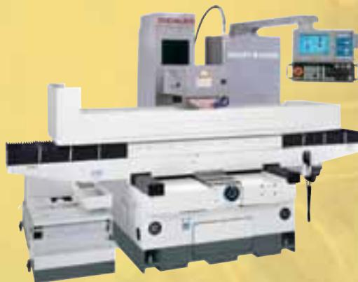
Профилешлифовальный станок с ЧПУ Smart-B1640II с управляемым поворотным столом NIKKEN CNC-105 для резьбошлифования и шлифования пулансонов и т. д.
