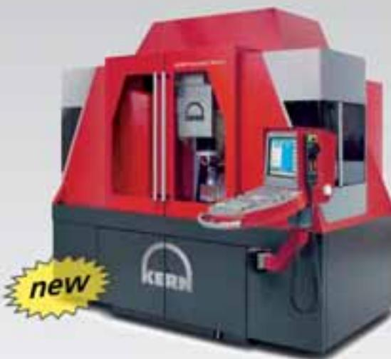
Нано-прецзионный обрабатывающий центр для с гидростатическими приводами и направляющими. Точность позиционирования в соответствии VDI/DGQ 3441 Ps ± 0,3 мкм. Шероховатость Ra < 0,05 мкм
