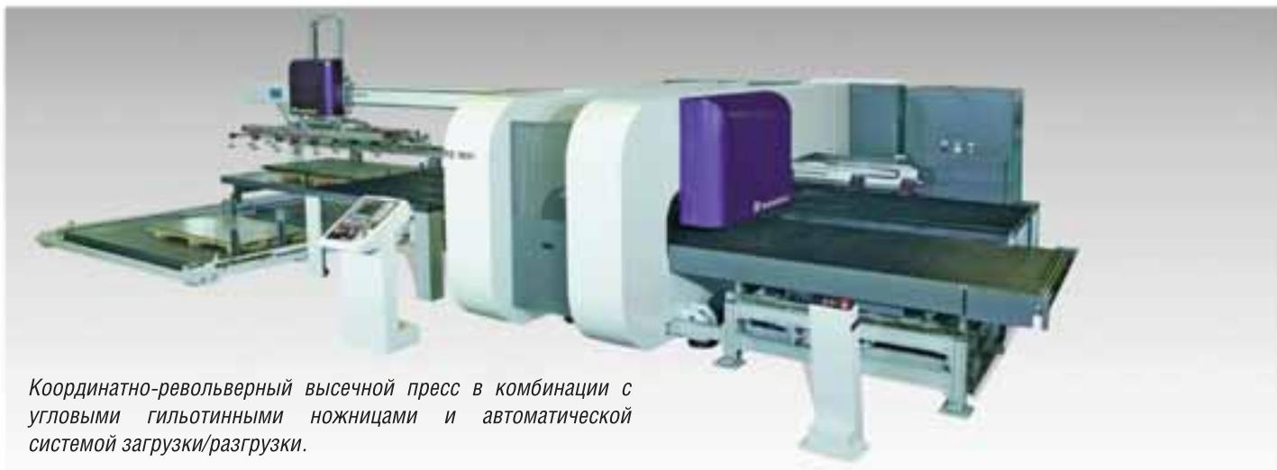
Координатно-револьверный высечной пресс в комбинации с угловыми гильотинными ножницами и автоматической системой загрузки/разгрузки.
