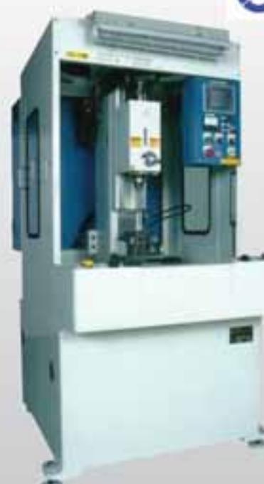
Автоматические суперпрецзионные станки для хонингования, суперфиниширования. (точность отклонения от круглости 0.5мкм), минимальный обрабатываемый Ø отверстия 2.5мм. [www.nissin-mfg.co.jp](http://www.nissin-mfg.co.jp)
