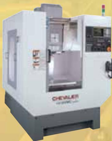
Компактный экономичный фрезерный обрабатывающий центр Falcon-1418VMC с системой управления Fanuc 0i-MC, со шпинделем 10000 об/мин, с поворотным столом, магазином инструмента на 12 инструментов, со скоростью быстрых перемещений по осям X/Y/Z 36 м/мин и т. д.
