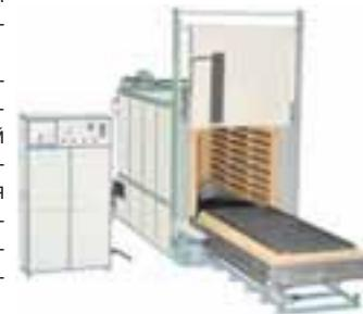
Управление нагревом электропечи, открытием двери и движением выкатного пода осуществляется с приборной панели шкафа управления, расположенного рядом с печью. Электропечи поставляются в виде футерованных легкособираемых модулей. Модульная конструкция крупных печей позволяет значительно облегчить тяжелажные и монтажные работы. Сборку печных модулей может провести даже эксплуатационный персонал, руководствуясь документацией, поставляемой с печью.
